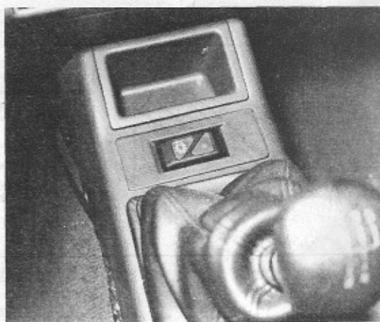
Contacteur intérieur du verrouillage automatique des portes (photo RTA).
