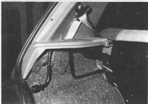
Emplacement de la manivelle de roue de secours (photo RTA).
