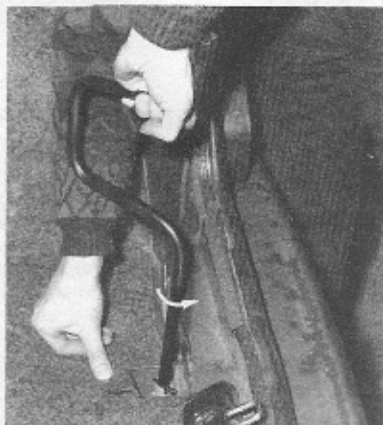
Débloquage du panier de roue de secours (photo RTA).
