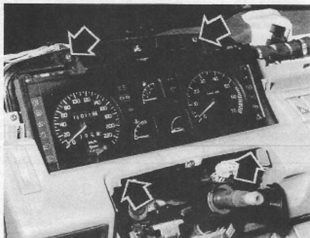
Dépose du combiné d'instruments Flèches : vis de fixation.
