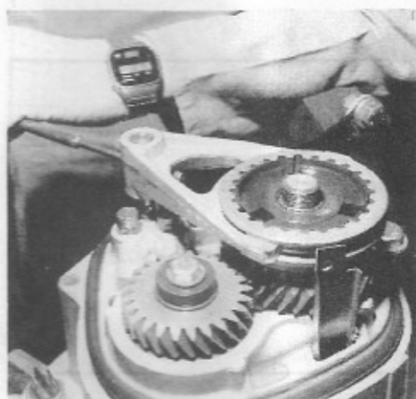
Dépose de la goupille de la fourchette de 5 e .
